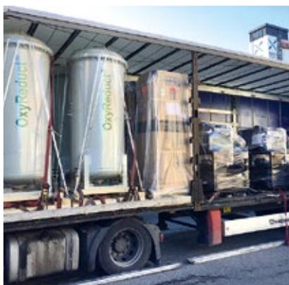
zwei energieeffizienten Stickstoffgeneratoren und der Sauerstoffsensoren OXY-SENS®. Das übergeordnete Steuersystem OxyControl® stellt sicher, dass alle acht Bereiche (Räume) überwacht und die Sauerstoffkonzentration jeweils konstant gehalten wird. Die installierte WAGNER Lösung stellt sicher, dass unter definierten Bedingungen eine Brandentwicklung nicht mehr möglich ist.
