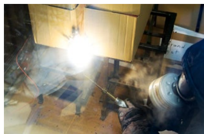
▲ Bei den Brandversuchen wurden Entzündungsgrenzen von Lagerwaren ermittelt.
